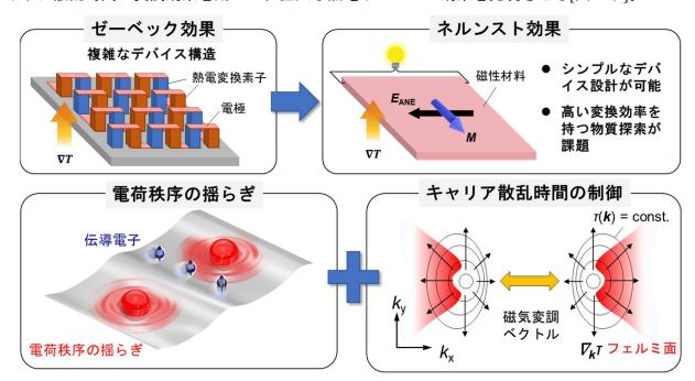
図 1. 本研究の概要。電荷秩序の揺らぎに起因する熱電ネルンスト効果を開拓する。
