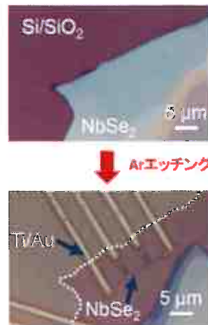
図2: シリコン基板上の膜厚 22 nm の NbSe 2 (上) と電子線描画装置及び Ar イオンエッチング装置によって加工された幅 300 nm の NbSe 2 細線 (下)。電極には Ti(5 nm) と Au(100 nm) を用いた。
