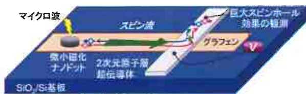
図6: 2次元原子層超伝導スピンホール素子を利用した超高感度磁気センサの概念図。
