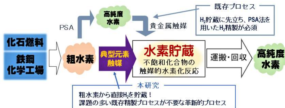
図 1. 既存の H 2 製造プロセスと本研究コンセプト
