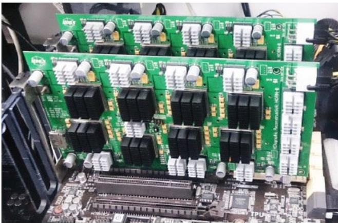
図 2: 世界最大規模の FPGA ボード
